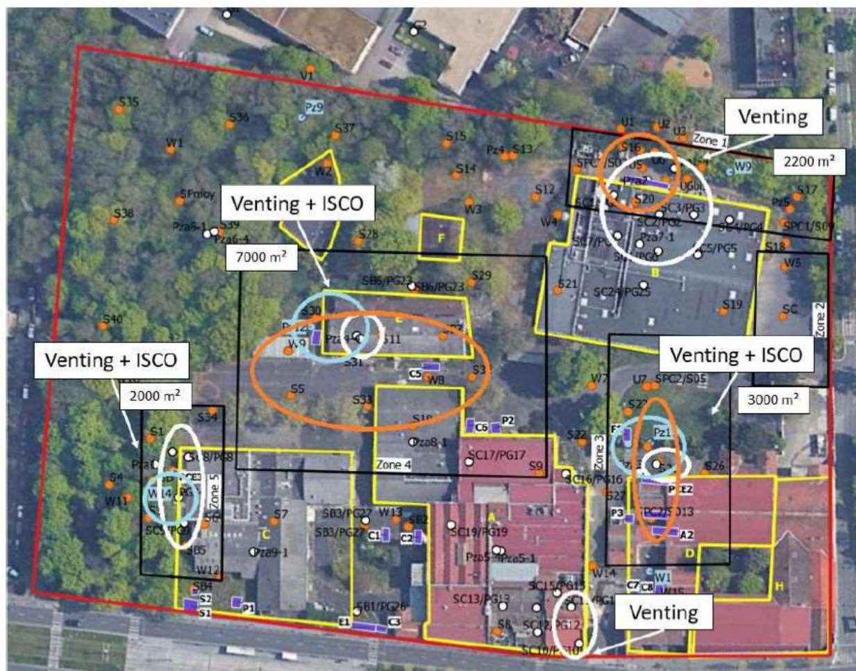
FIGURE 31 : SYNTHÈSE DES ZONES À DÉPOLLUER ET DES TECHNIQUES RETENUES, LES OVALES BLEUS REPRÉSENTENT LA POLLUTION DES EAUX SOUTERRAINES, LES ORANGES LA POLLUTION DES SOLS ET LES BLANCS LA POLLUTION DES GAZ DU SOL.
